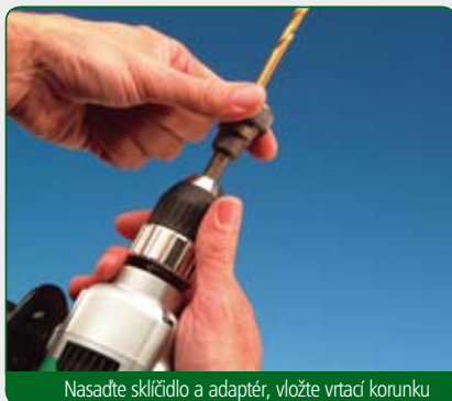
Nasadte sklíčidlo a adaptér, vložte vrtací korunku
